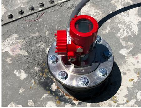
ResinView® es compatible con muchos tipos de sensores de nivel. Las formas de resina granular, en polvo, en escamas o líquida pueden requerir diferentes tipos de tecnología de sensor. Los radares sin contacto, SmartBobs y láseres se utilizan a menudo para el control de la resina. No hay energía en el depósito, no hay problema: los sensores alimentados por batería facilitan la instalación. ResinView® es compatible con sensores que utilizan salidas analógicas o 4-20 mA, Modbus o HART.
